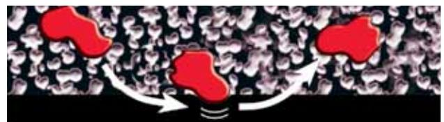
**FLOWROX VENTIL:** Wenn Partikel auf die Gummioberfläche der Manschette treffen, wird die Kollisionsenergie absorbiert und beim Zurückprallen des Partikels sofort wieder abgegeben. Dies führt zu einer hervorragenden Verschleißfestigkeit und langen Wartungsintervallen.
